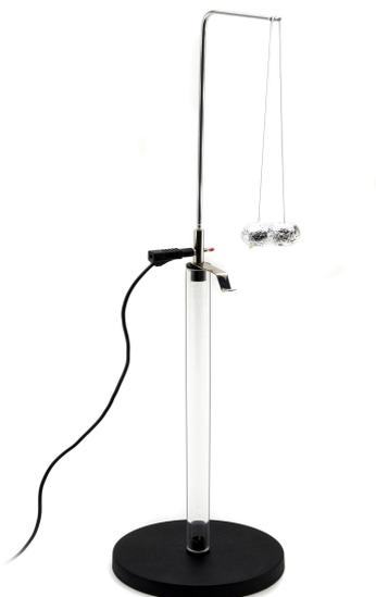
Le cariche dello stesso segno si dispongono sulla superficie delle due palline e di conseguenza, i due pendoli si respingono.
