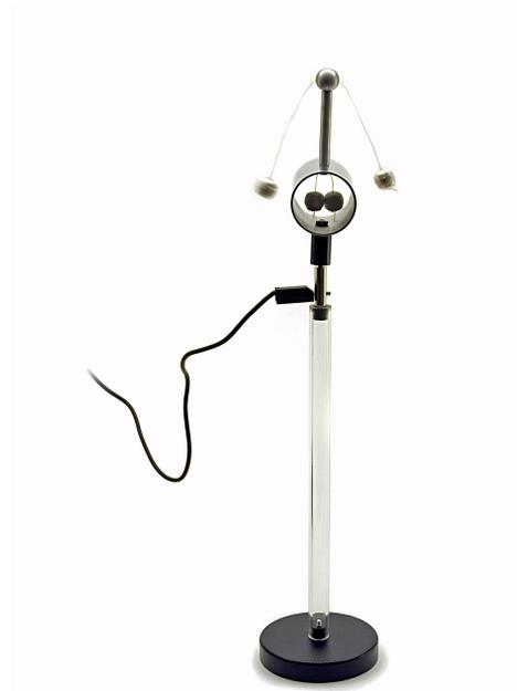
Come mostra il disegno e come si vede dalla foto, le palline che sono a contatto con la parte metallica esterna del cilindro divergono mentre quelle che si trovano all'interno rimangono ferme, a dimostrazione che la carica si distribuisce sempre sulla superficie esterna dei conduttori.
