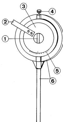
Der Verstellbare Spalt findet überall dort in der Optik Verwendung, wo ein kontinuierlich und reproduzierbar verstellbarer Spalt erforderlich ist, insbesondere also bei Beugungs- und Interferenzversuchen sowie bei spektraler Zerlegung.
